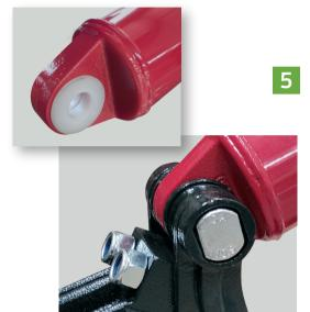
Colocar los casquillos superiores (11) a ambos lados del tubo protector del muelle (10). Atornillar el tubo a la cabeza del chisel con el otro tornillo bulón (16), la arandela (17) y la tuerca (18).
